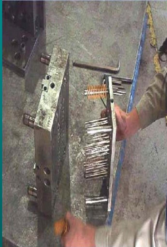
将模板上的模仁固定螺栓拆下
