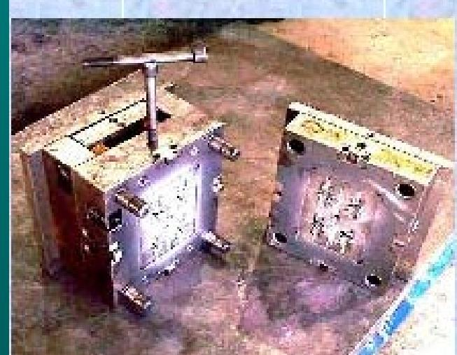
公模底板上与模框连接的螺栓卸下,然后将公模固定板和模脚一起拉出,放于一旁
